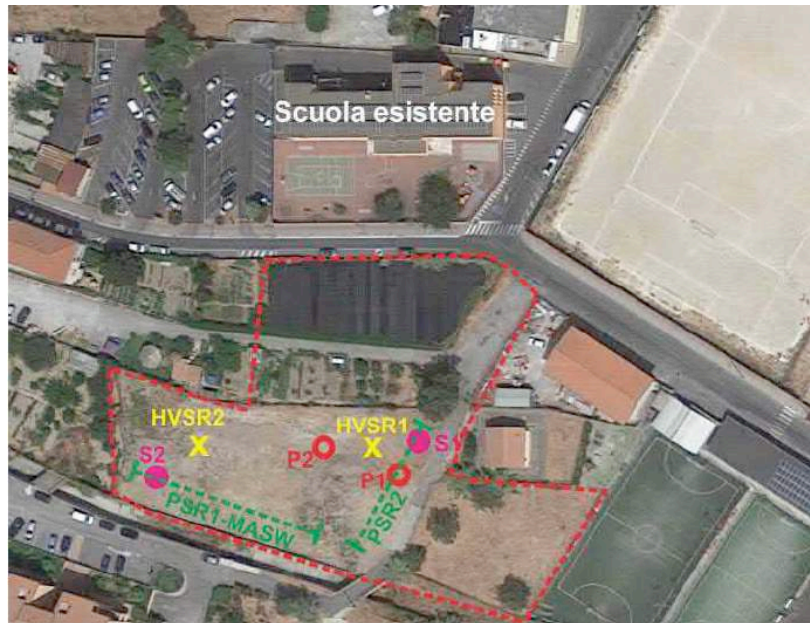
fig. 7. Posizionamento dei sondaggi geognostici (i carotaggi sono denominati come S1 e S2)
