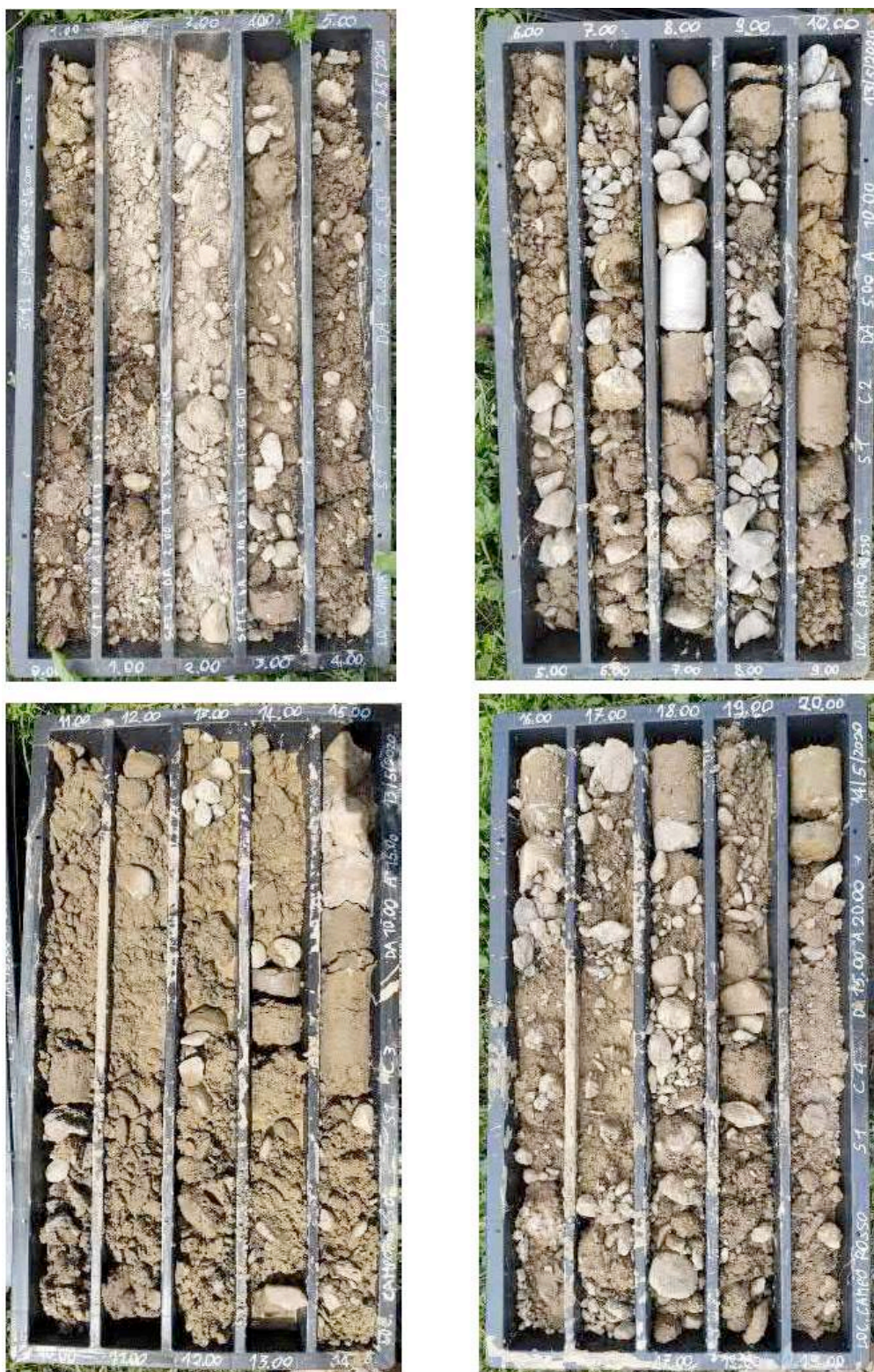
fig. 8. Il sondaggio geognostico S1
